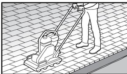
**Paso 5:** Compacte los adoquines antes de que el EdgeCrete endurezca. Instale el material de junta adecuado según las instrucciones del fabricante. Para resultados óptimos, use arena polimérica PolySweep, arena para juntas o PermChips de SEK-Surebond.
