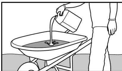
**Paso 2:** En una tolva de mezclado o carretilla, mezcle 1/2 galón de agua con cada bolsa de 50 lb de EdgeCrete hasta que todo el contenido seco esté mezclado y la mezcla sea suave y consistente. For efficiency, mix 2 bags with 1 gallon of water if project size allows.
